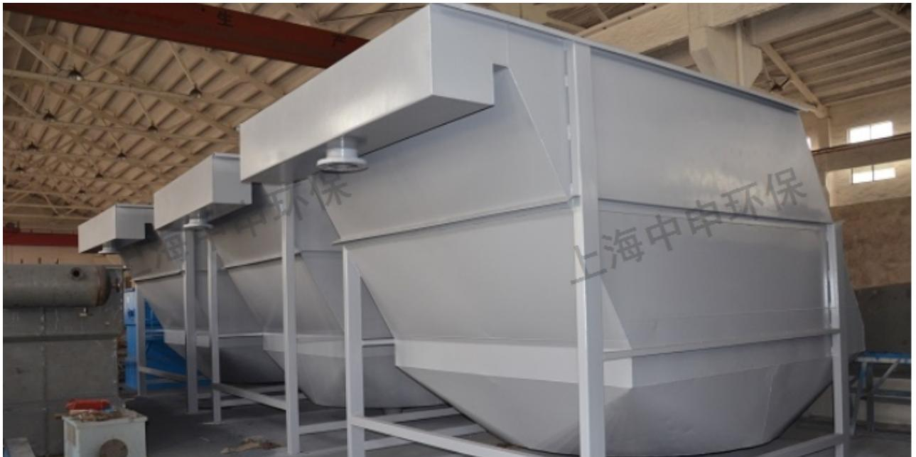
蜂窝斜板（管）沉淀是把与水平面成一定角度（一般为 $60^{\circ}$ 。）的众多蜂窝斜板（管）组件置于沉淀池中。水流可从下向上或从上向流动，颗粒则沉于底部，而后自动滑下。从改善沉淀池水力条件来分析，由于沉淀池水力半径大大减小，从而使雷诺数R大为降低，弗劳德数大为提高，满足了水流稳定性和层流的要求。为了进一步提高沉淀效率，许多改良型的蜂窝斜板（管）沉淀池应运而生。湿周大，水力半径小。层流状态好，颗粒沉降不受絮流干扰。当斜管管长为1米时，有效负荷按 $3\text{--}5\text{吨}/(\text{米}^2 \cdot \text{时})$ 设计，出水水质比较好。在取水口处采用蜂窝斜管，管长 $\sim$ ，可在 $50\text{--}100\text{公斤}/\text{米}^3$ 泥砂含量的高浓度中安全运行处理。采用斜管沉淀池，其处理能力是平流式沉淀池的3-5倍，加速澄清池和脉冲澄清池的2-3倍。
